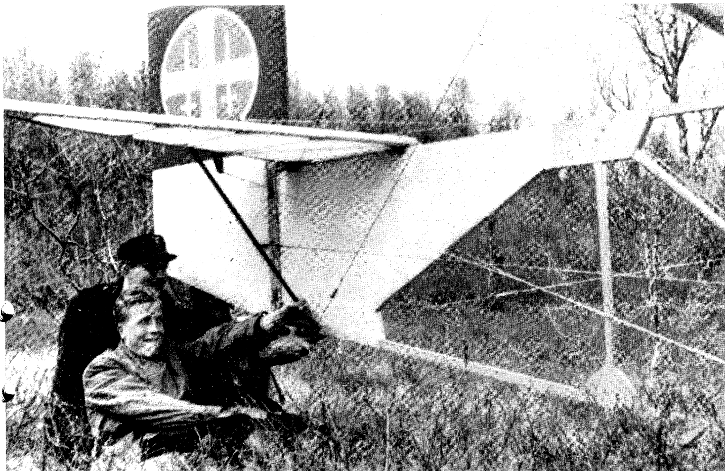
Disse to bilder viser en typisk strikkstart med Grunau 9 LN-GAO. Kommandoropene var: Hold! Løp! Slipp! Hvor bildene er tatt er ukjent. (Foto via Norsk Teknisk Museum).
